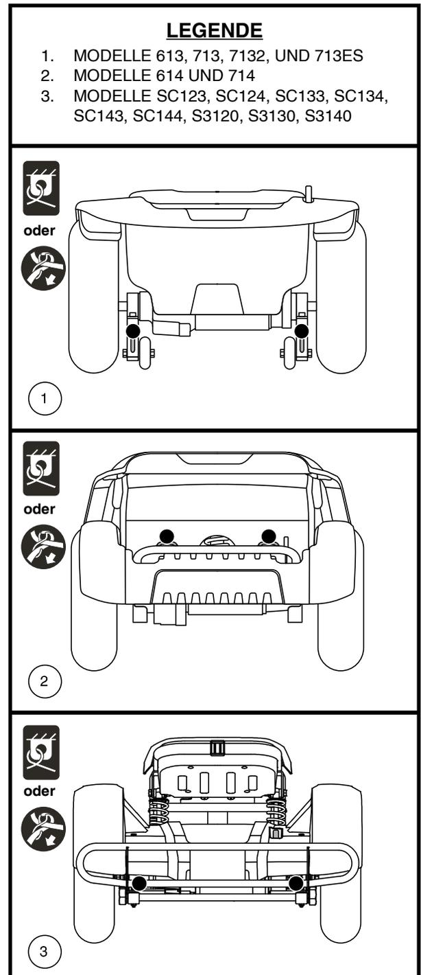
Abb. 11. Hintere sicherungspunkte (Durch schwarze Punkte gekennzeichnet)
