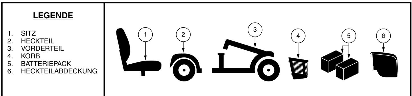
Abb. 25. Elektromobil Komponenten
