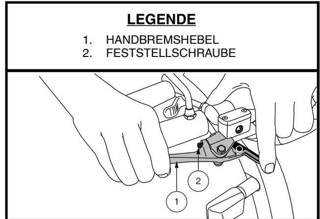
Abb. 3 Handbremshebel
