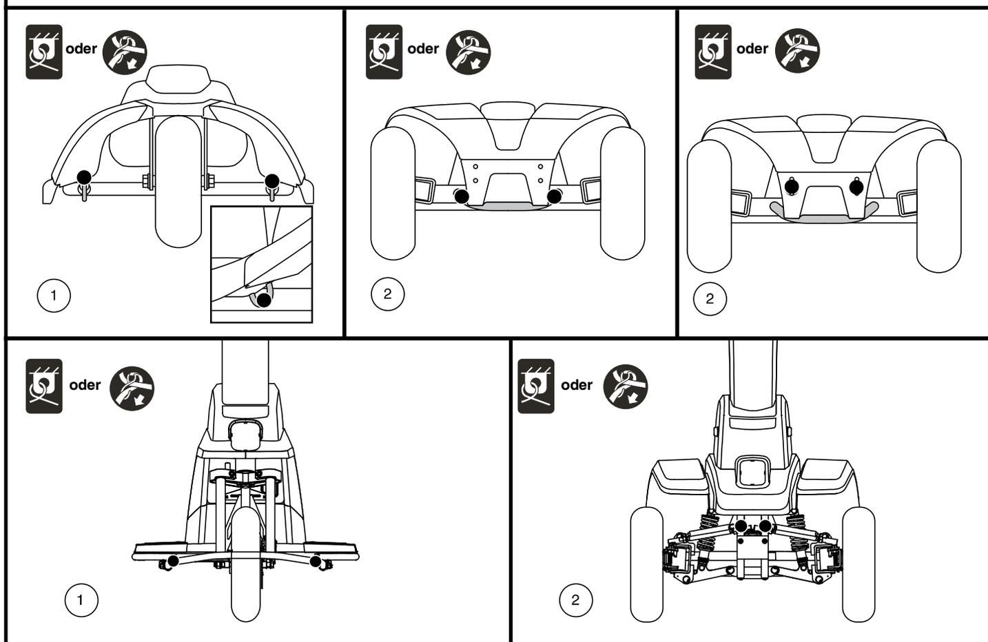
Abb. 12. Vordere sicherungspunkte (Durch schwarze Punkte gekennzeichnet)
