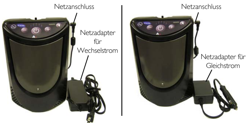
ABB 6.3 Aufladen der internen Batterie
