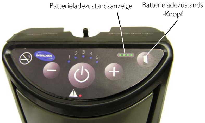
ABB 6.2 Überprüfen des Ladezustands der internen Batterie
