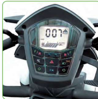
Tages- und Gesamtkilometer, Batteriestand, Geschwindigkeit, Uhrzeit und Temperaturanzeige
