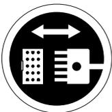
Ausrichtung des Zentralverbindungssteckers.
