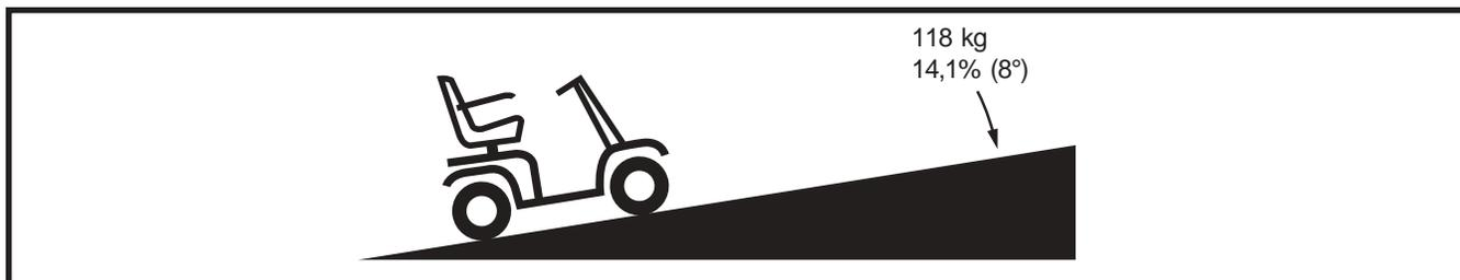
Abb. 1. Maximal empfohlene Steigung
