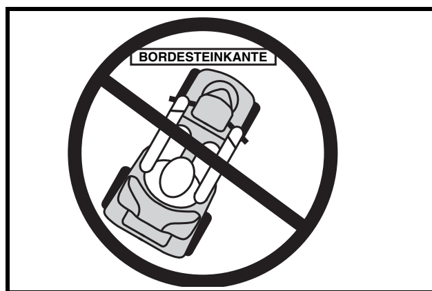
Abb. 3A. Falsches Anfahren einer Bordsteinkante
