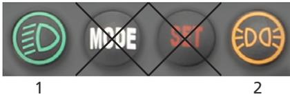
Um die Lichtanlage in Betrieb zu nehmen muss sich der Schlüssel im Schloss befinden, und der Scooter muss eingeschaltet sein. Bei ausgeschaltetem Scooter ist die Lichtanlage aus und nicht nutzbar. Nach Neustart ist die Grundeinstellung "Scheinwerfer und Licht AUS"
