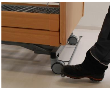
Bremsbügel nach unten festdrücken bis er einrastet: die 4 Laufrollen sind festgestellt
