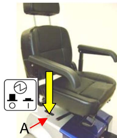
Der automatische Stromunterbrecher befindet sich auf der hinteren Abdeckung unter dem Sitz.
