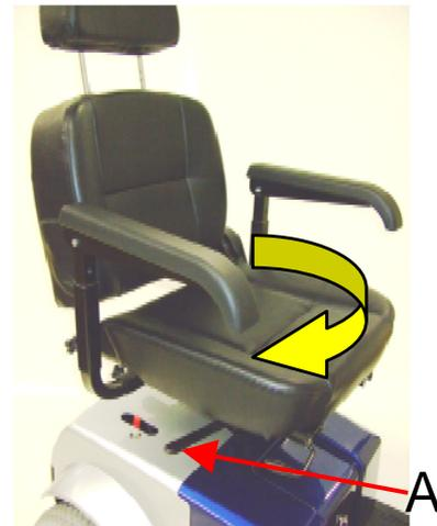
Sobald der Sitz wieder in seine normale Position gedreht wird, rastet er automatisch ein. Hierdurch ist sichergestellt, dass der Sitz sich während der Fahrt nicht spontan dreht.
